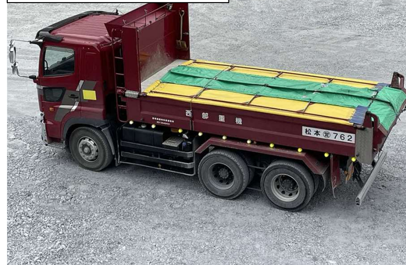
防塵シート敷設状況
